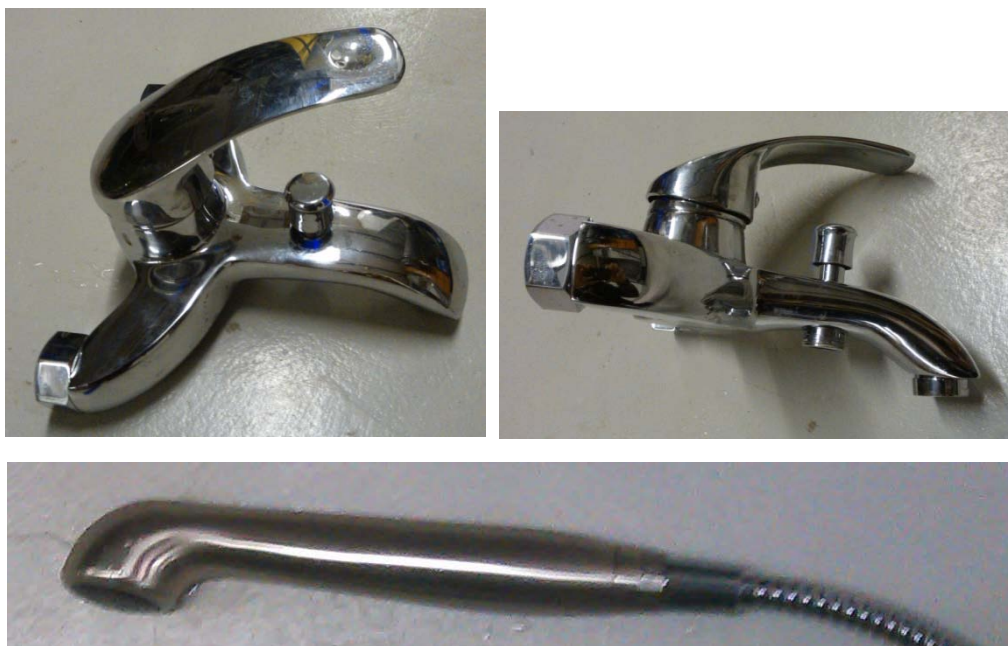
Kuva 1. Mitattu suihkuhana 10503 suihkusekoittaja juoksuputkella ja käsिसuihkuosalla.
