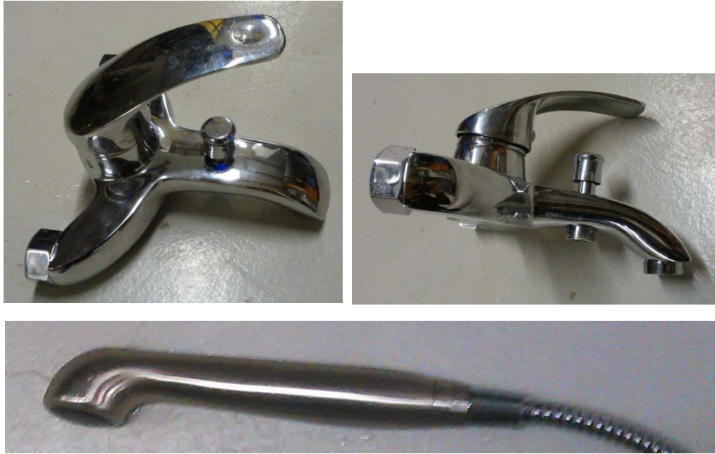
Kuva 1. Mitattu suihkuhana 10503 suihkusekoittaja juoksuputkella ja käsिसuihkuosalla.
