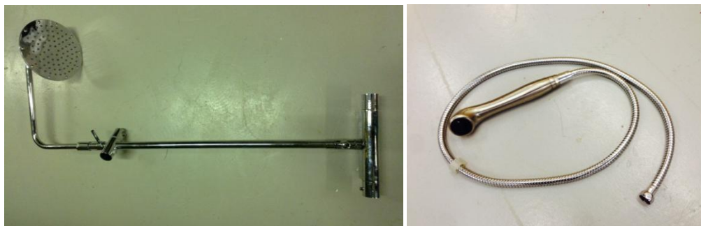
Kuva 1. Mitattu suihkuhana Saga sadesuihkulla ja käsisuihkuosa.
